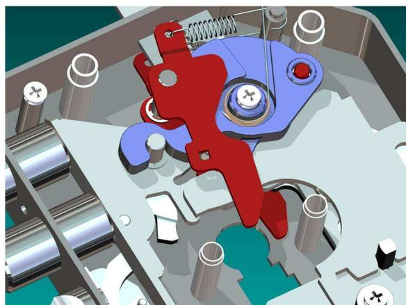
Серия сверхпрочных многоканальных замков на основе цилиндрического механизма для стальных и бронированных дверей.
